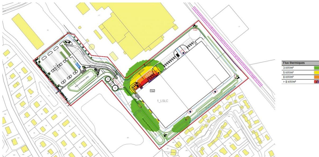
Figure 38: Flux thermiques de la cellule 1
