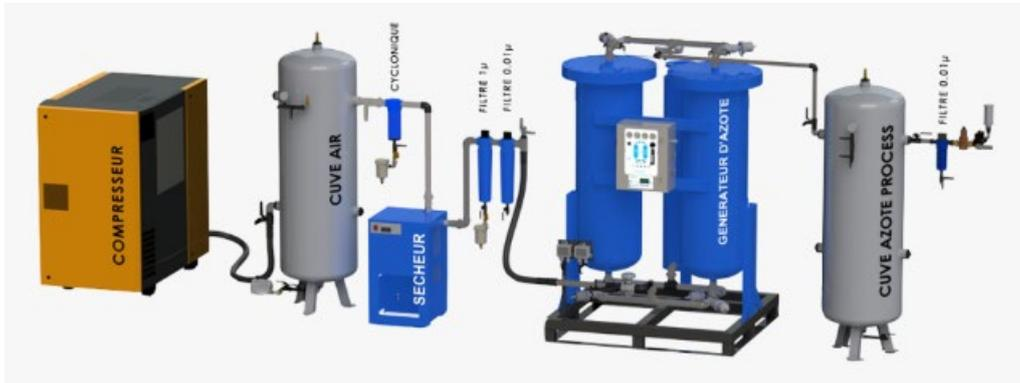
Figure 8: Illustration du processus de production d'azote
