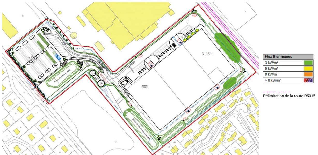
Figure 43: Flux thermiques de la cellule 3 (1511)
