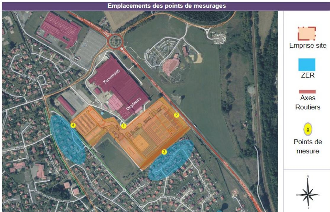
Figure 26: Emplacements des points de mesurages acoustiques
