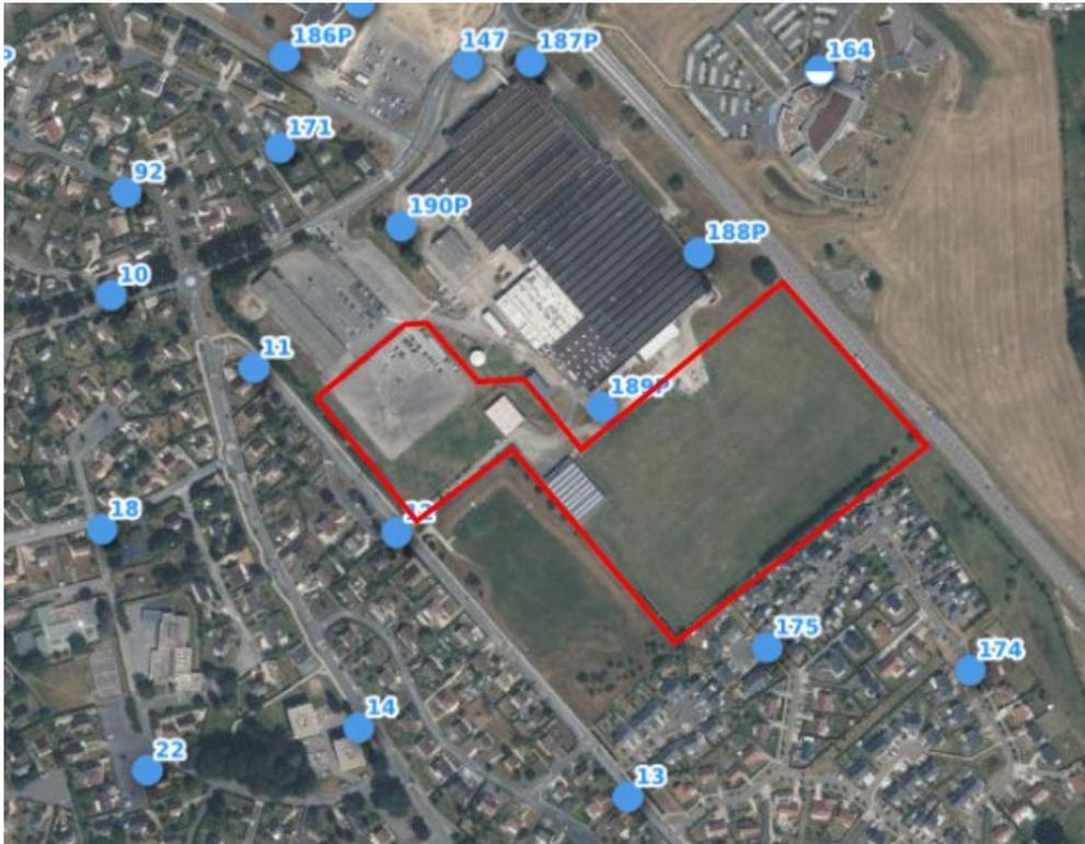
Figure 9: Emplacement des poteaux incendie à proximité du projet
