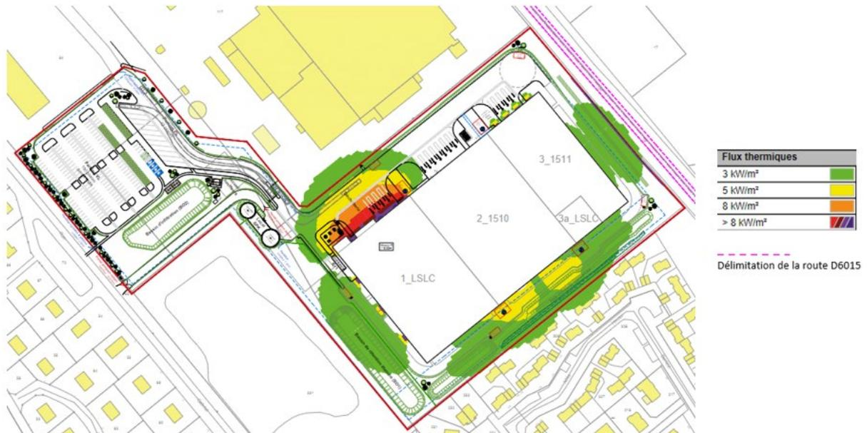
Figure 49: Plan des flux thermiques cellules seules, cas majorants
